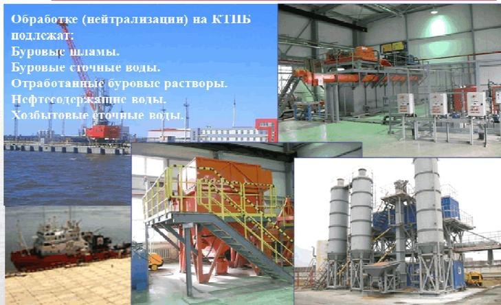
В основу комплекса впервые на Каспии был положен принцип “нулевого сброса”, исключающий попадание каких бы то ни было отходов в море. В соответствии с этим принципом все отходы с буровых платформ вывозятся на берег для дальнейших обезвреживания и утилизации.
