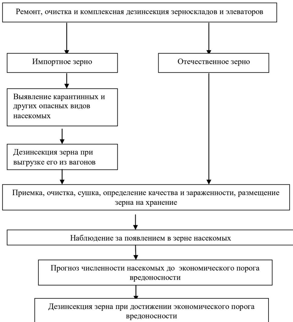
Рис. 2. Принципиальная схема системы защиты хранящегося зерна от насекомых.
